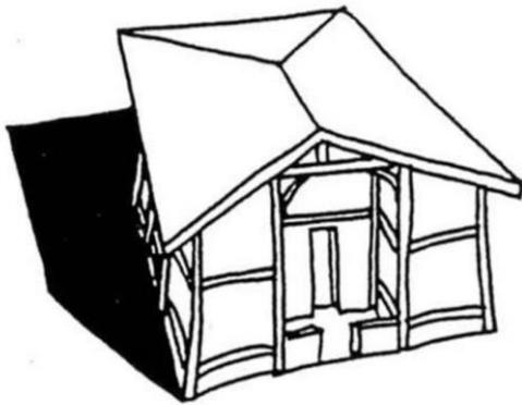
Les façades sont toujours protégées. Derrière l'enduit ou le badigeon, les matériaux dépendent des disponibilités : pans de bois remplis de torchis ou de briques dans la lande : maçonneries de moellons ou galets, parfois associées à des pans de bois et adobes en pays d'Adour. Près du Béarn, des toits raidis se couvrent de tuiles plates
